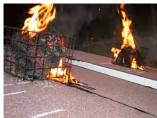
Typischer Dachaufbau mit Bitumenbahnen und Brandversuch
