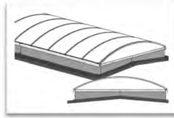
Einbau auf dem First Dachwinkel symmetrisch / Kopfstück gerade
