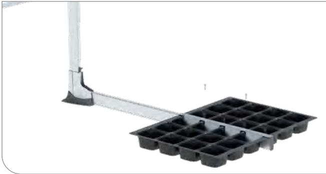
Lastaufnahmeplatten auf dem Basiselement nach Plan anordnen. Befestigungsprofil auflegen und mit zwei mitgelieferten Bohrschrauben (4,8 x 25 mm; 3 Nm) sichern. Zur vorübergehenden Lagesicherung z. B. mit Kies beschweren.
