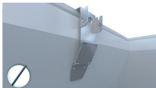
5. Bohrlöcher anzeichnen Mark holes
