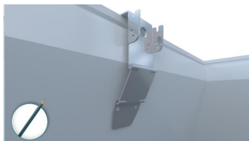
5. Bohrlöcher anzeichnen Mark holes
