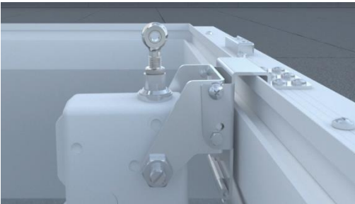
9. Öffner an Grundplatte verschrauben Fix opener with screw and nut
