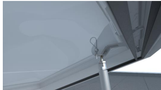
12. Bolzen und Federstecker einstecken Put in bolt and cotter pin
