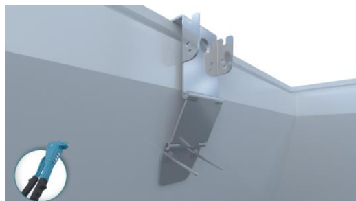
7. Universal Grundplatte festnieten Fix universal base plate with rivets
